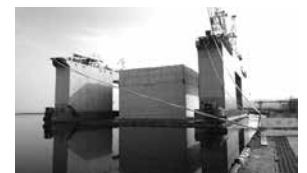
釧路西港区に係留 12,000t 積 ケーソン製作用台船
