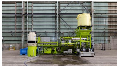
▲バイオコックス製造装置
